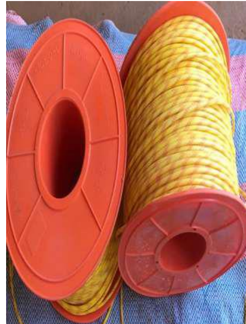
5 200 mètres de cordons détonants
